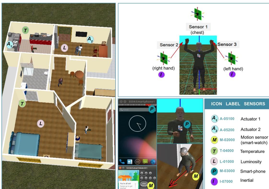
Figura 8.12: Posición de los sensores en la simulación de los casos de estudio.
